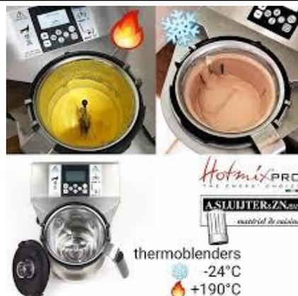
HotmixPRO - линейка инновационных многофункциональных устройств, единственных в своем роде. Благодаря специальным ножам они могут работать как миксер для жидкостей, так и как куттер для твердых ингредиентов.
