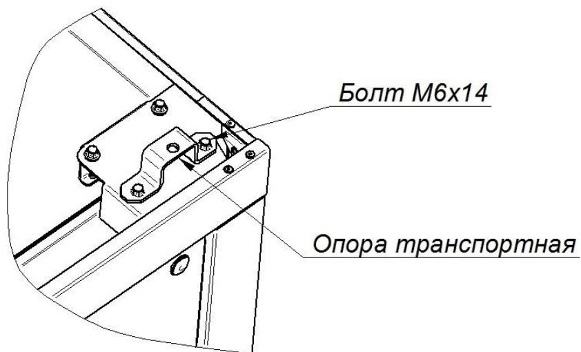
Рис.1 Вид снизу. Демонтаж опоры транспортной.
