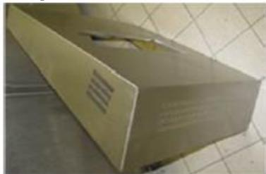
Поднимите и снимите колпак крышки.
