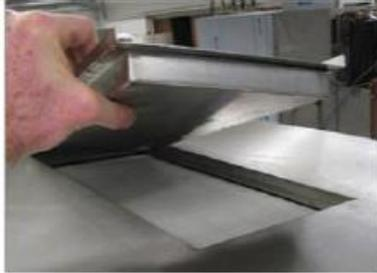
Для очистки пластин конденсатора снимите смотровую панель (Рисунок 1) на колпаке утилизации тепла и осторожно окатите пластины водой из шланга.
