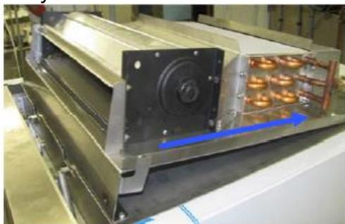
Бак (Рисунки 5 и 6) утилизации тепла можно протереть в зависимости от степени загрязнения.
