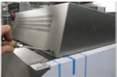
Для очистки всей утилизации отходящего тепла открутите оба винта на передней стороне колпака утилизации тепла.
