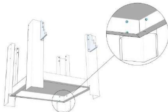
2. Закрепить стойки винтами M6.
